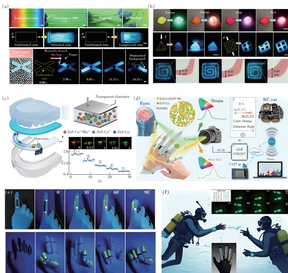
图 12 力致发光触觉传感器在软体机器人、人机交互以及手势识别场景的应用示例。(a)软体机器人中的可视化力致发光反馈 [118] ;(b)活体复合软体机器人的多色力致发光显示 [119] ;(c)基于力致发光牙套的人机交互 [98] ;(d)全光学触觉交互与无线控制 [17] ;(e)自供能力致发光器件的手势识别 [120] ;(f)水下手势识别与无源光通信 [60]
